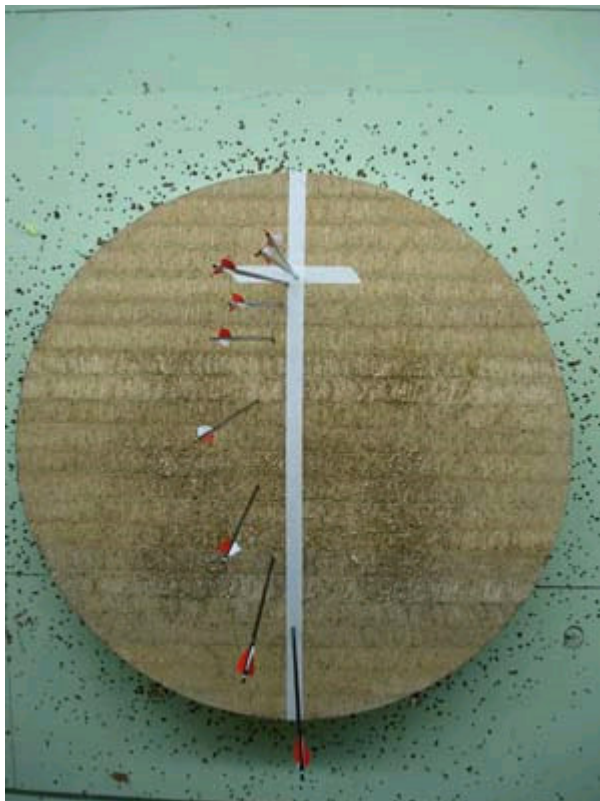
Bild 1: Button zu weit aus dem Bogenfenster draußen Bauch nach links Botten vom Pfeil weg Richtung Bogenfenster schrauben raus schrauben
